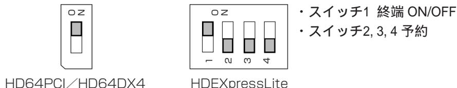
図2-5 RF75Ω終端スイッチ図
